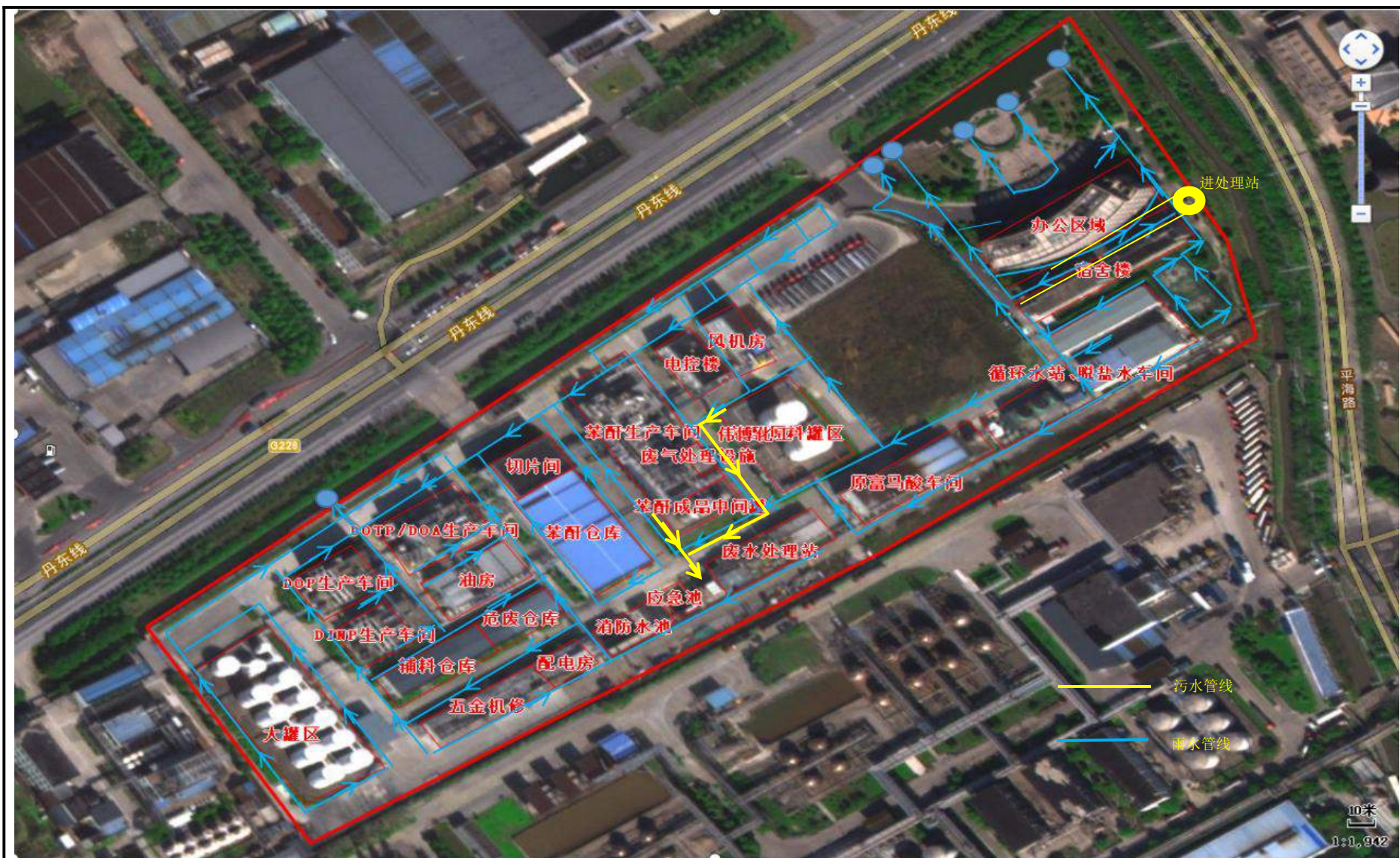
图4.2-3 厂区内雨污水管网示意图
